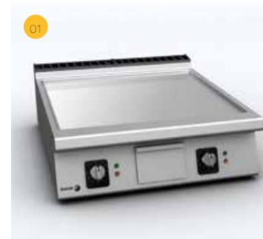
01. Superficie revestida con un baño de cromo duro de 50 micras. El mantenimiento de calor que proporciona la superficie cromada evita la pérdida por irradiación y la dispersión del calor, reduciendo el tiempo de asado, el tiempo de recuperación de temperatura, y creando un ambiente de trabajo más confortable. Además, el revestimiento de cromo facilita la limpieza de la plancha.
